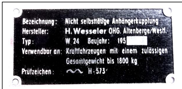
Typenschild „Wesseler-Anhänger-Kupplung“ W 24, bis 1800 kg (Größe 60 x 30 mm) (Kopie von TÜV-Bauartgenehmigung vorhanden)
