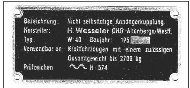
Typenschild „Wesseler-Anhänger-Kupplung“ W 40, bis 2700 kg (Größe 60 x 30 mm) (Kopie von TÜV-Bauartgenehmigung vorhanden)
