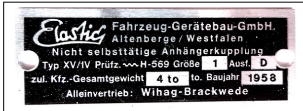
Typenschild „Elastic-Anhänger-Kupplung“ Größe 1, 4 to (Größe 55 x 20 mm) (Kopie von TÜV-Bauartgenehmigung vorhanden)
